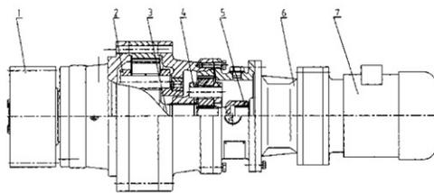
1. 一种用于风力发电的偏航减速机，它主要由制动电动机、摆线针轮减速机、高速端太阳轮、高速端行星减速机构、低速端太阳轮、低速端行星减速机构、输出齿轮、花键、平键、轴承、销钉和螺钉等紧固件所组成，其特征是：制动电动机（7）通过螺钉、平键固连一台摆线针轮减速机（6），该摆线针轮减速机（6）的输出轴通过花键联结高速端太阳轮（5），此高速端太阳轮（5）啮合高速端行星减速机构（4），该高速端行星减速机构（4）的输出轴通过花键联结低速端太阳轮（3），其低速端太阳轮（3）啮合低速端行星减速机构（2），此低速端行星减速机构（2）的输出轴通过花键联结输出齿轮（1）。
